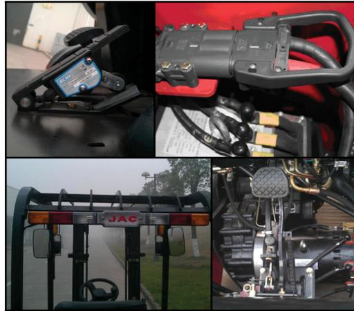
Conector de fuente de alimentación REMA para una conexión de alimentación muy conveniente
